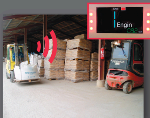
Signal de détection d'un engin
